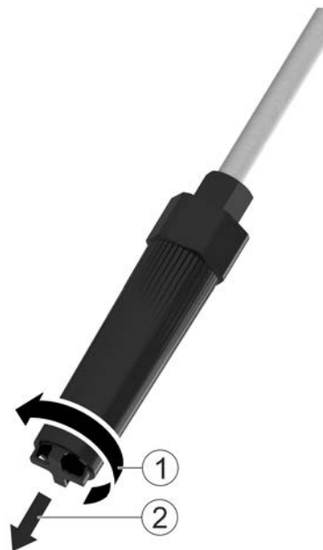
Obr. 34: Výměna filtrační svíčky
