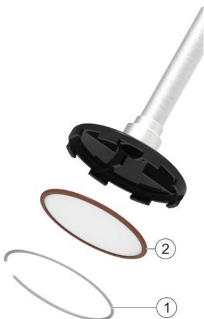
Obr. 33: Výměna talířového filtru
